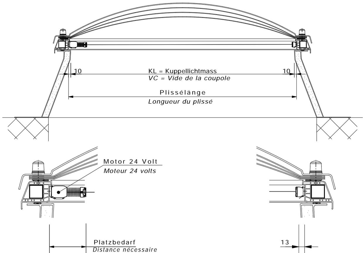
Plissé aus Stoff für Innenanwendung, horizontal eingebaut im Lüfterrahmen
