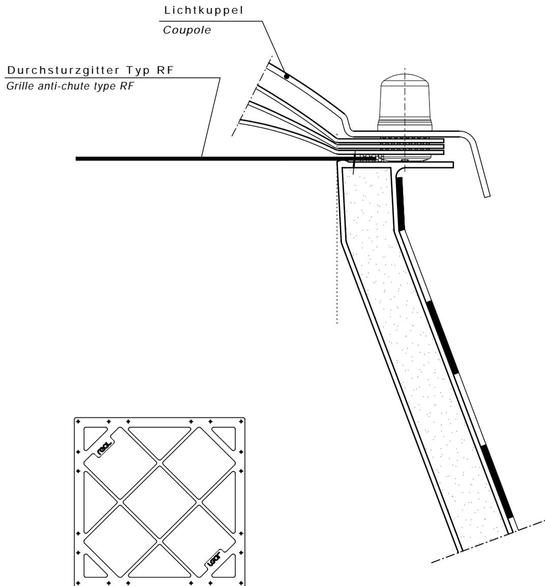
REAL Lichtkuppel mit Aufsatzkranz und Durchsturzgitter Typ RF
